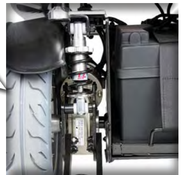
Federung an den Antriebsrädern einstellbar
