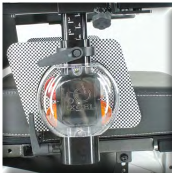
Beleuchtung nach StVZO stoßgeschützt
