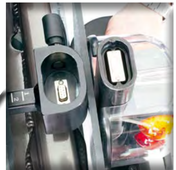
Plug & Play Steckerkontakte an den Armlehnen
